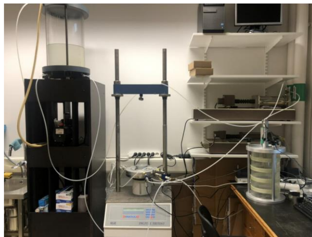
Figur 6 Triaxial provuppställning i LTH Geotekniska Laboratorium
